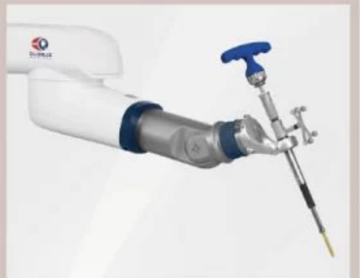
Ο βραχίονας κατευθύνεται ρομποτικά στην κατάλληλη θέση ώστε να εκτελεστεί με ακρίβεια χιλιοστού η εντολή του χειρουργού, καθοδηγώντας τα εργαλεία του.
